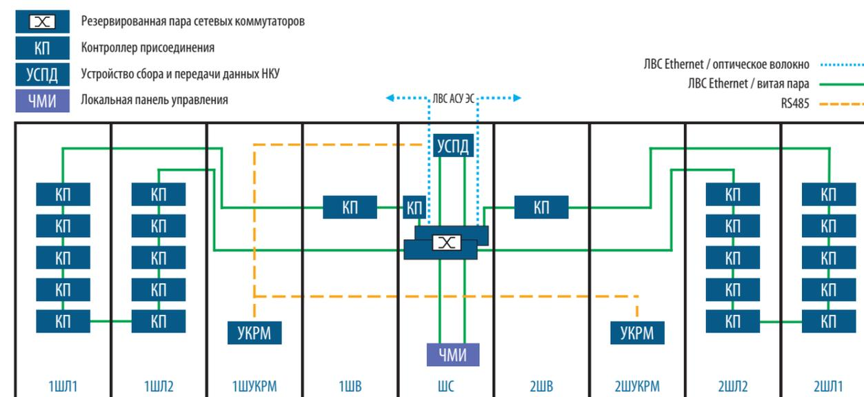
Рис. 34. Структурная схема цифровой НКУ «Ассоль» Digital
