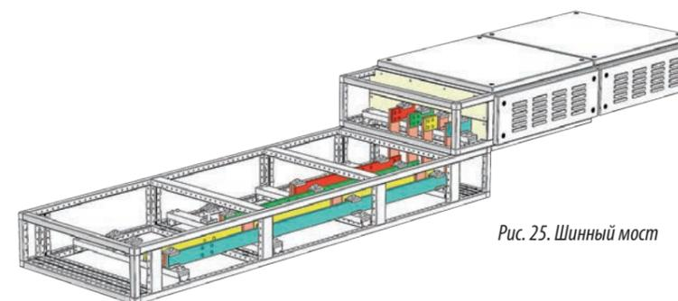
Рис. 25. Шинный мост
