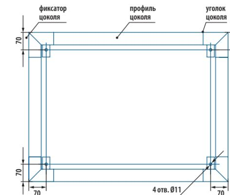
Рис. 36. Места крепления цоколя фиксаторами
