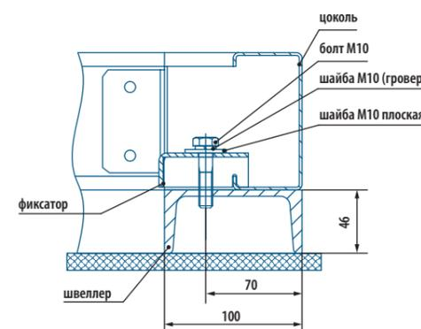
Рис. 35. Крепление цоколя к раме с помощью фиксаторов
