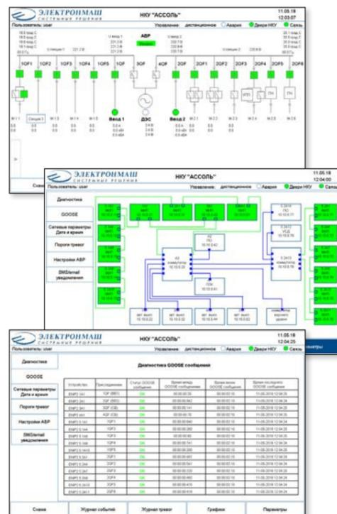
Рис. 31. Экраны системы мониторинга и управления НКУ
