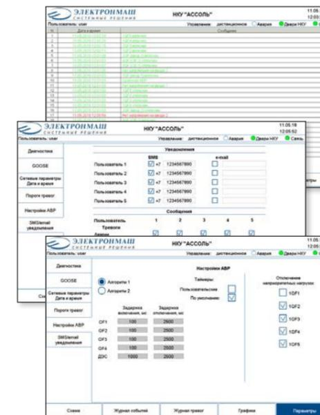
Рис. 33. Экраны системы мониторинга и управления НКУ
