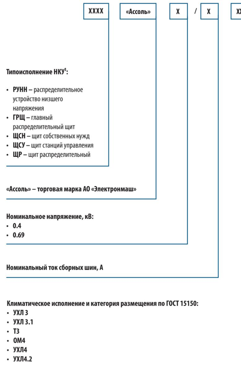
Пример записи условного обозначения главного распределительного щита номинальным напряжением 0.4 кВ с номинальным током сборных шин 3200 А, климатического исполнения УХЛ, категории размещения 3.1:
