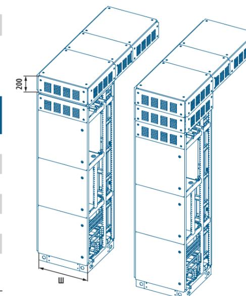
Рис. 27. Пример подключения шинного моста
