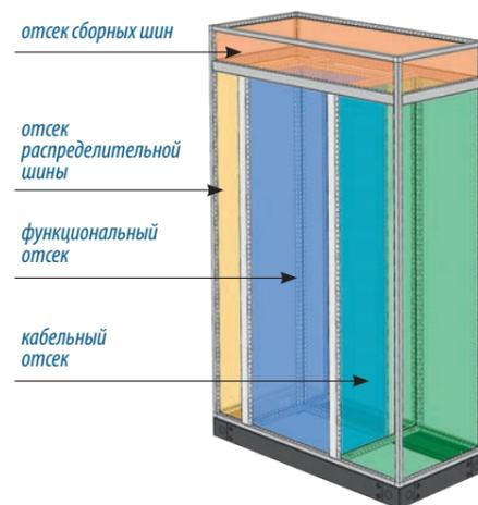
Рис. 8. Разделение шкафа ШР на отсеки
