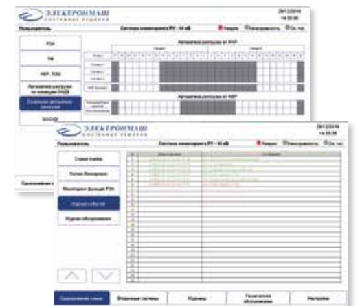
Рис. 34. Экраны системы мониторинга и управления КРУ
