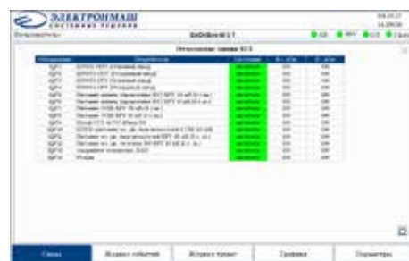
Рис. 13. Экран пофидерного контроля изоляции
