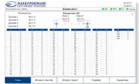
Рис. 14. Экран поэлементного контроля АБ
